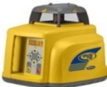
**LASER EXTERIEUR A SIMPLE PENTE - GL413**
