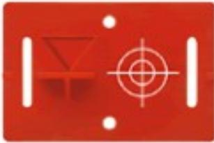
pour les mesurages du tassement, pour un positionnement rapide avec un tachéomètre
