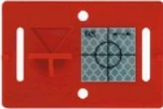
pour les mesurages du tassement, la pose de la mire graduée est possible pour un positionnement rapide avec un tachéomètre
